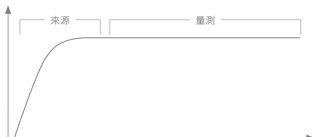
圖 4. 取樣訊號的 SMU 孔徑時間圖解
