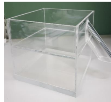
Fig 15. 用於測量熱板密度之容器
