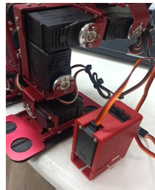
圖 11 塑膠卡榫嵌合示意
