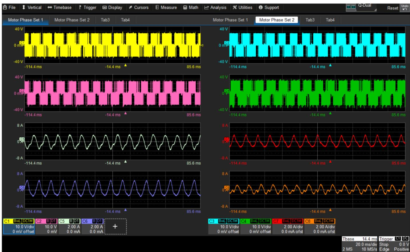
圖 1：此屏幕截圖顯示了在 200 毫秒內為電機驅動器的兩個繞組組輸出中的每一個採集兩個電壓和兩個電流
