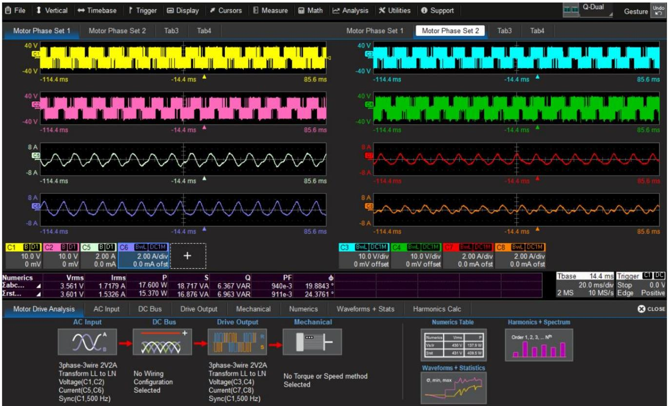
圖 2：電機驅動分析設置摘要和顯示靜態功率計算的數值表
