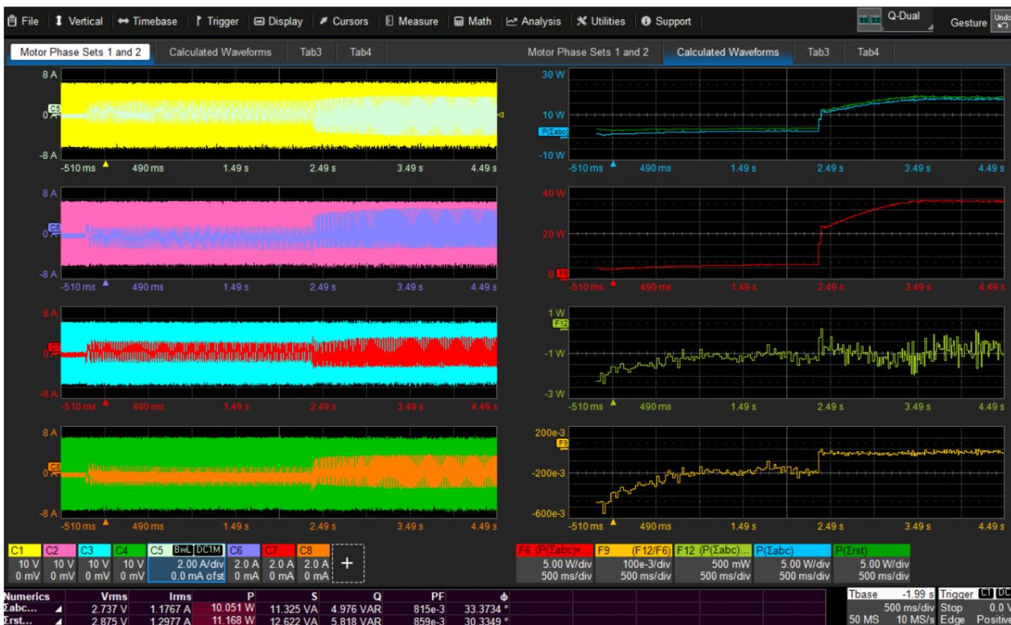
圖 4：六相電機動態電壓電流信號採集與功率等計算波形。
