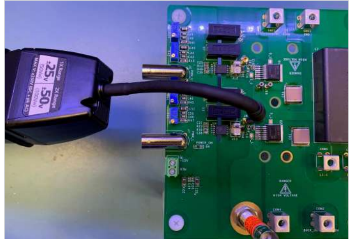
圖 13. MMCX 連接器 - 範例 2。照片來源 ©Wolfspeed。經許可轉載。
