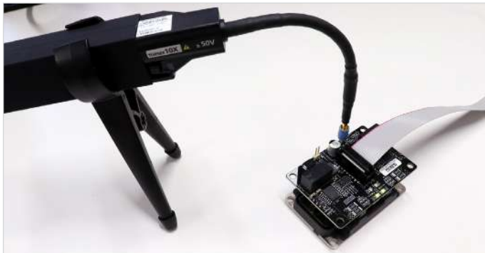
圖 15. 方形針腳感應器探棒頭纜線。照片來源 ©Wolfspeed。經許可轉載。
