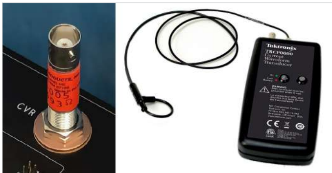
圖 7. 探棒範例，(a) 電流觀察電阻 (T & M Research SSDN005，400 MHz)。照片來源 ©Wolfspeed。經許可轉載。(b) Rogowski 電流探棒 (TRCP0600 電流波形感應器，30 MHz)。
